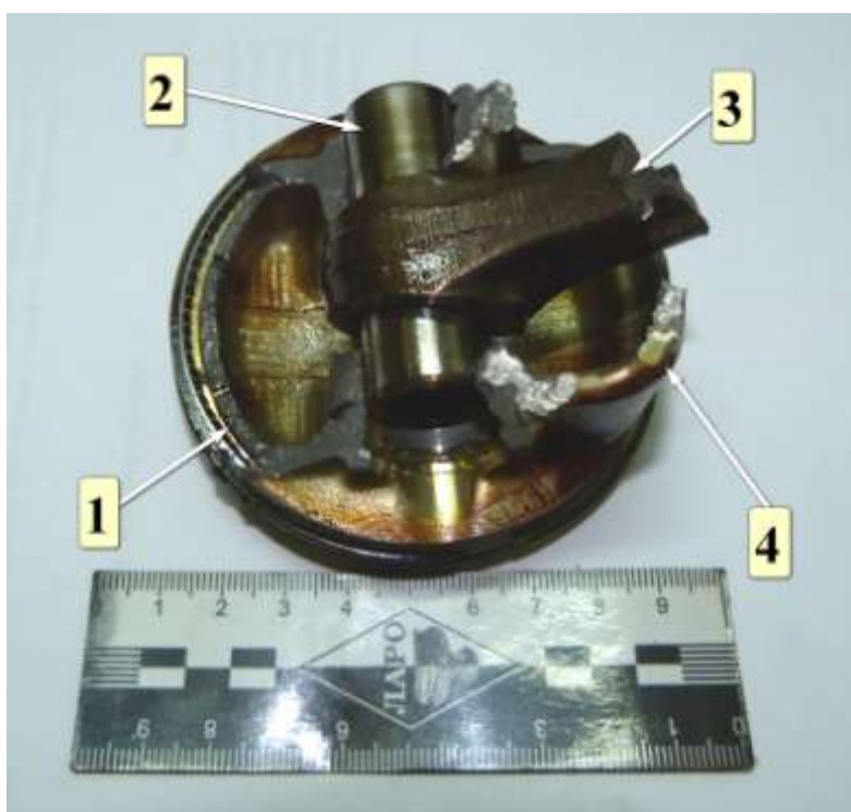
Фото 21. Поршень 4-го цилиндра (вид снизу): 1 – полностью разрушенная юбка поршня; 2 – поршневой палец; 3 – верхняя часть шатуна; 4 – сохранившийся фрагмент юбки поршня
