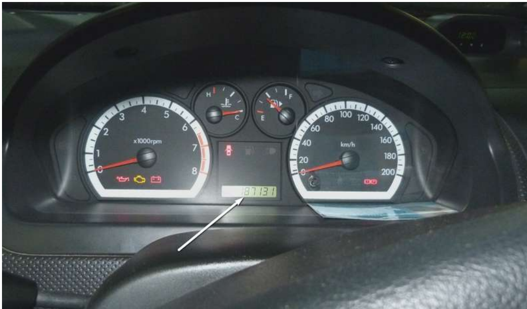
Фото 5. Комбинация приборов автомобиля Chevrolet Aveo, VIN KL1SFXXXXXXXXXXXX, гос. № XXXXXXXXXXXXX: одометр показан стрелкой
