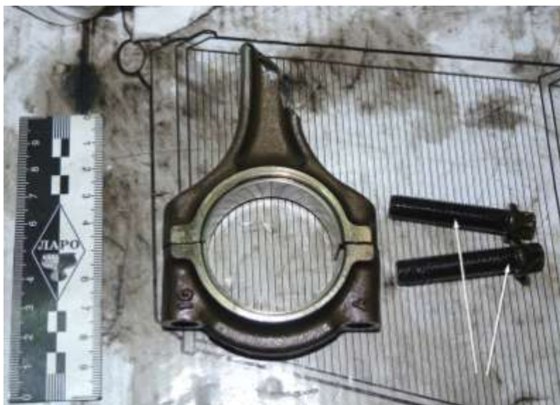
Фото 17. Болты (показаны стрелками) крепления крышки шатуна 4-го цилиндра
