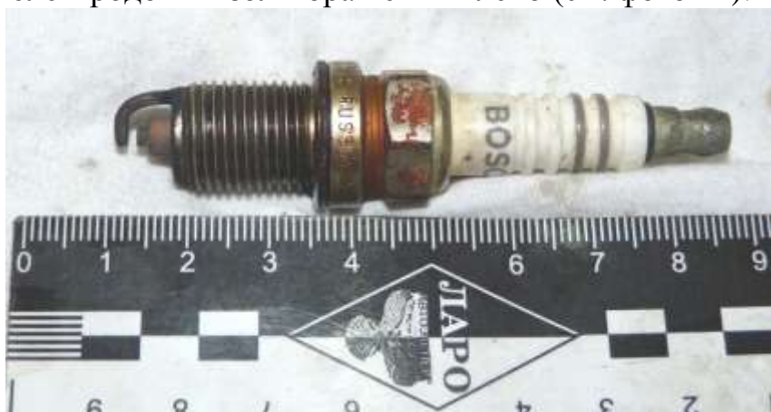
Фото 11. Свеча 4-го цилиндра. Электроды и изолятор – без повреждений
