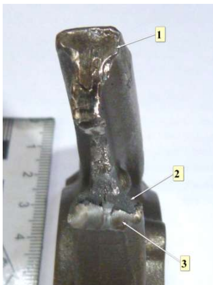
Фото 25. Поверхность излома на нижнем фрагменте шатуна (увеличено): 1 и 3 – пластически деформированные участки; 2 – участок с мелкозернистой поверхностью
