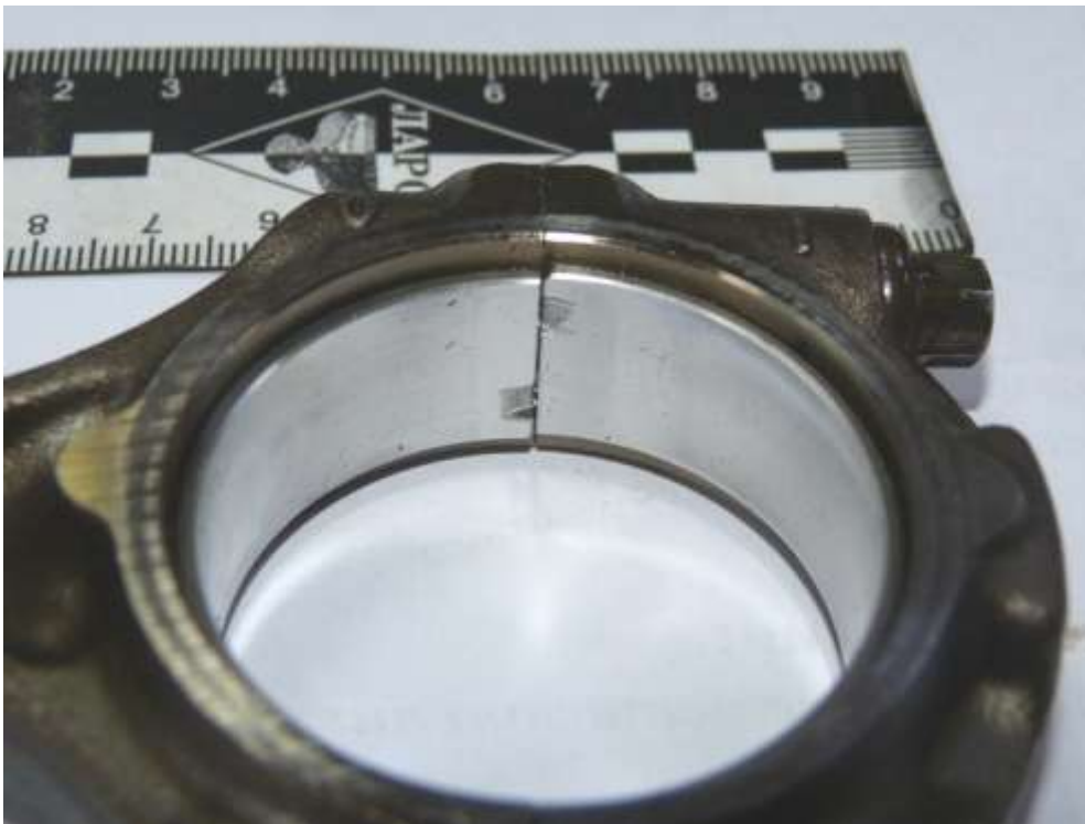
Фото 29. Вкладыши шатунного подшипника 4-го цилиндра
