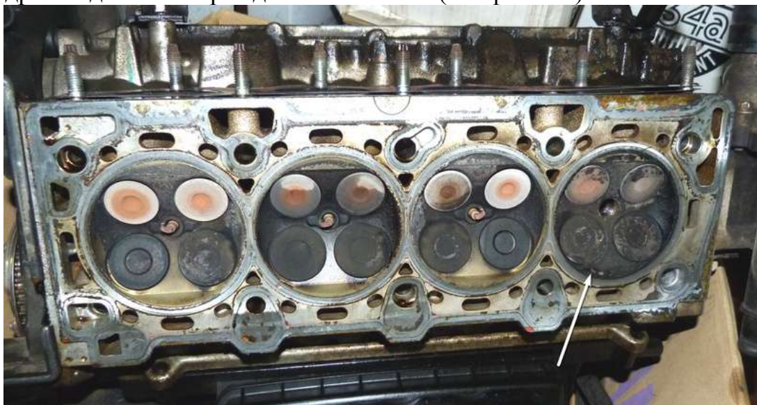
Фото 18. Привалочная плоскость головки блока. Стрелкой показана камера сгорания 4-го цилиндра
