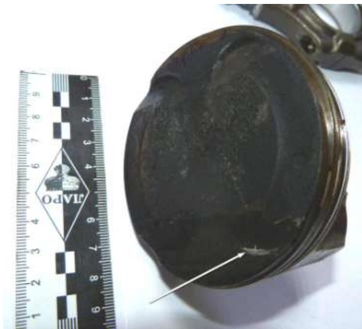
Фото 23. Днище поршня 4-го цилиндра: стрелкой показан след от контакта с тарелкой клапана
