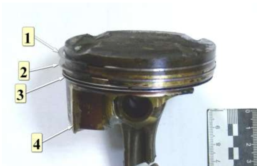
Фото 22. Поршень 4-го цилиндра (вид сбоку): 1 – верхнее компрессионное кольцо; 2 – второе компрессионное кольцо; 3 – маслосъемное кольцо; 4 – сохранившийся фрагмент юбки поршня
