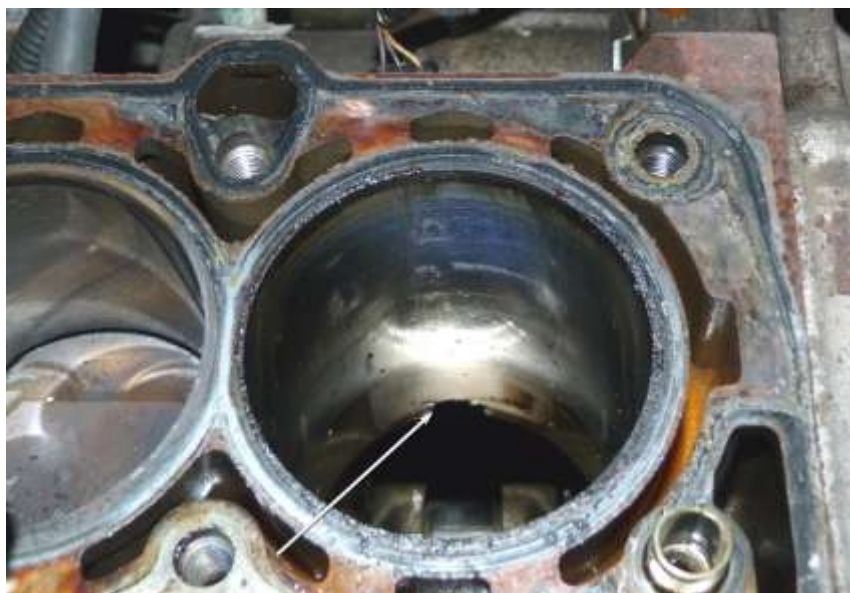
Фото 20. Пролом (показан стрелкой) в нижней части 4-го цилиндра
