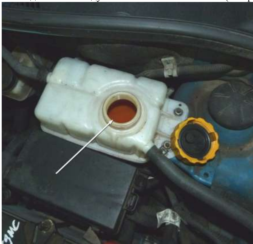
Фото 10. Охлаждающая жидкость (показана стрелкой) в расширительном бачке
