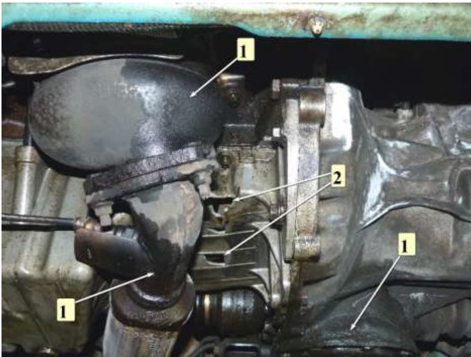
Фото 8. Вид снизу/спереди на силовой агрегат: 1 – пятна масла; 2 – отверстия в поддоне двигателя
