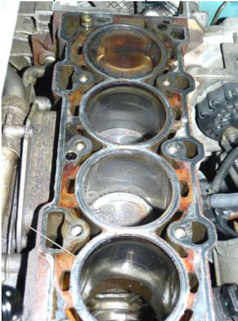
Фото 19. Исследуемый двигатель с демонтированной головкой блока: 4-й цилиндр показан стрелкой
