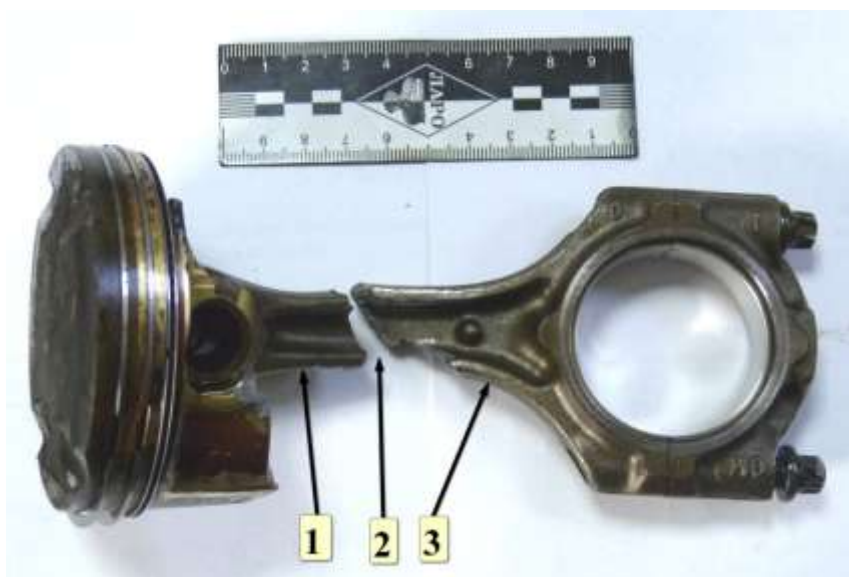
Фото 24. Шатун 4-го цилиндра: 1 – верхний фрагмент шатуна с поршневым пальцем и поршнем; 2 – место излома; 3 – нижний фрагмент шатуна
