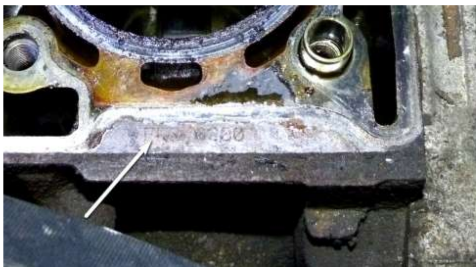
Фото 4. Обозначение модели двигателя (показано стрелкой) на блоке цилиндров
