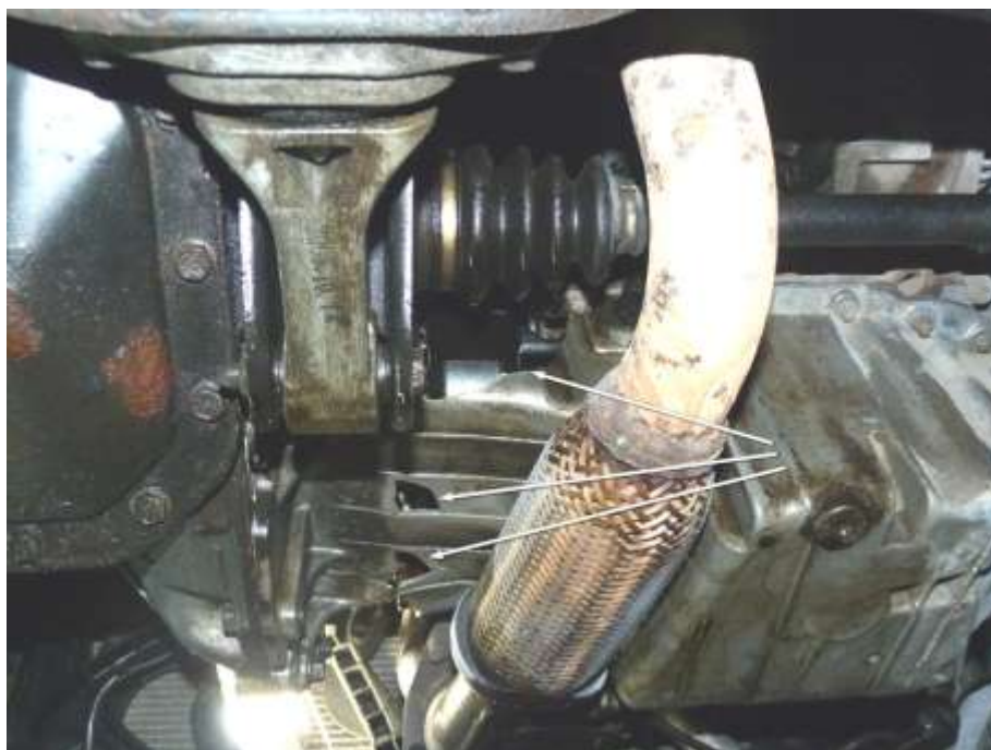
Фото 9. Вид снизу/сзади на силовой агрегат. Отверстия в поддоне двигателя показаны стрелками
